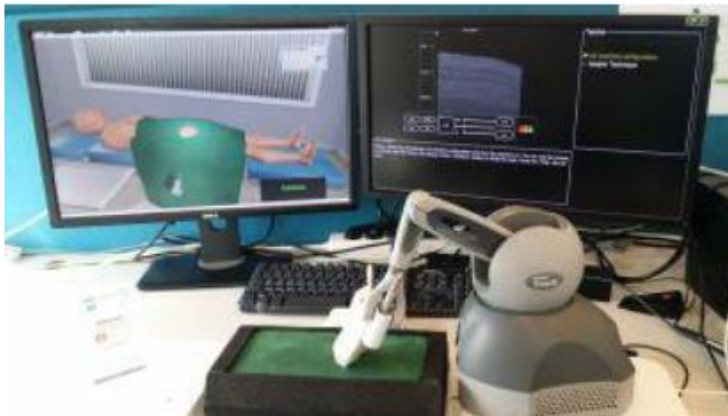
Симулятор для для местной анестезии (Regional Anaesthesia Simulator (RASim)) с прототипом тактильного устройства с иглой. Система предполагает два экрана для изображения виртуального пациента (слева) и учебного курса (справа).
