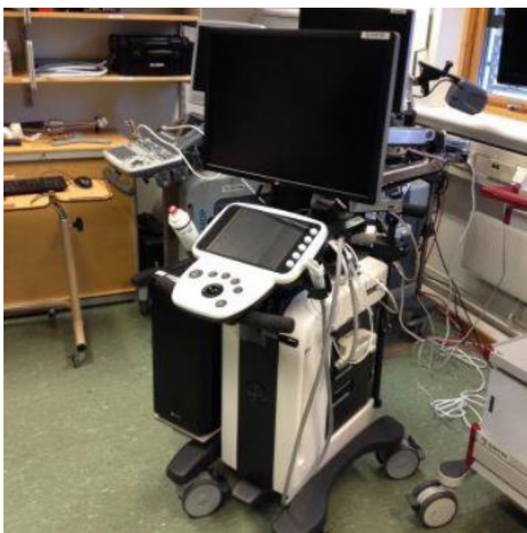
Система ассистирования для местной анестезии (Regional Anesthesia Assistant System (RAAs)) включает систему ультразвукового исследования, датчиков магнитного слежения, дополнительного компьютерного оборудования, а также большого экрана
